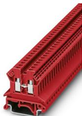
Borne de passagem, tensão nominal: 800 V, corrente nominal: 24 A, quantidade de conexões: 2, tipo de conexão: Conexão a parafuso, Bitola: 2,5 mm<sup>2</sup>, perfil de conexão: 0,2 mm<sup>2</sup> - 4 mm<sup>2</sup>, tipo de montagem: NS 35/7,5, NS 35/15, NS 32, cor: vermelho
