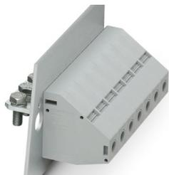
Bloco terminal de passagem de painel, tipo de conexão: Conexão por rosqueamento com luva de tração, Conexão de terminal de cabos, número de polos: 1, corrente de carga: 150 A, perfil de conexão: 16 mm<sup>2</sup> - 50 mm<sup>2</sup>, direção de conexão do condutor para a direção de encaixe: -90 °, largura: 18,8 mm
