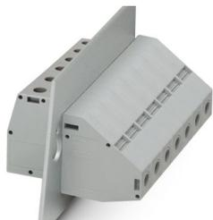
Bloco terminal de passagem de painel, tipo de conexão: Conexão por rosqueamento com luva de tração, Conexão por rosqueamento com luva de tração, número de polos: 1, corrente de carga: 150 A, perfil de conexão: 16 mm<sup>2</sup> - 50 mm<sup>2</sup>, direção de conexão do condutor para a direção de encaixe: -90 °, largura: 18,8 mm
