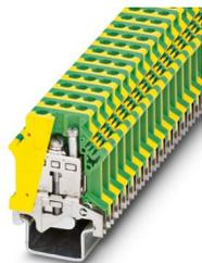
Borne terra, quantidade de conexões: 2, número de polos: 1, tipo de conexão: Conexão a parafuso, perfil de conexão: 0,5 mm<sup>2</sup> - 16 mm<sup>2</sup>, tipo de montagem: NS 35/15-2,3, cor: verde-amarelo
