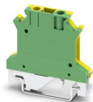
Borne terra, quantidade de conexões: 2, número de polos: 1, tipo de conexão: Conexão a parafuso, perfil de conexão: 0,2 mm<sup>2</sup> - 4 mm<sup>2</sup>, tipo de fixação: Base PE com parafuso de fixação, M3, tipo de montagem: NS 35/7,5, NS 35/15, NS 32, cor: verde-amarelo
