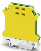
Borne terra, Na disposição em borne de passagem com a mesma forma, aplicar uma tampa > 690 V para as tensões de isolamento, quantidade de conexões: 2, número de polos: 1, tipo de conexão: Conexão a parafuso, Bitola: 4 mm<sup>2</sup>, perfil de conexão: 0,2 mm<sup>2</sup> - 4 mm<sup>2</sup>, tipo de montagem: NS 35/7,5, NS 35/15, NS 32, cor: verde-amarelo
